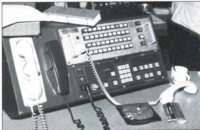
Teleraailbedienplaats in de VL-centrale in Utrecht. Duidelijk zijn de displays voor het kanaalnummer en het treinnummer te zien.
